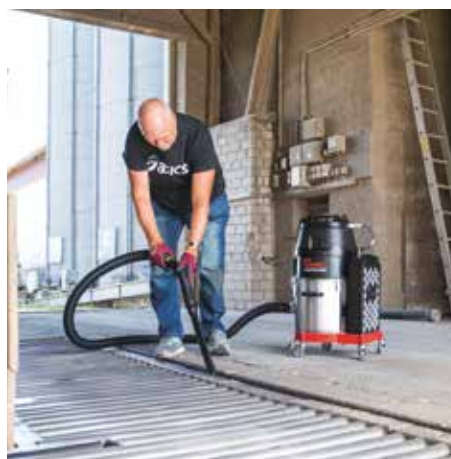
R18 D Aspiration de résidus de céréales dans des joints étroits
