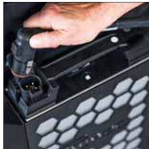
Lösen der Steckverbindung und leichte Entnahme des Akkus
