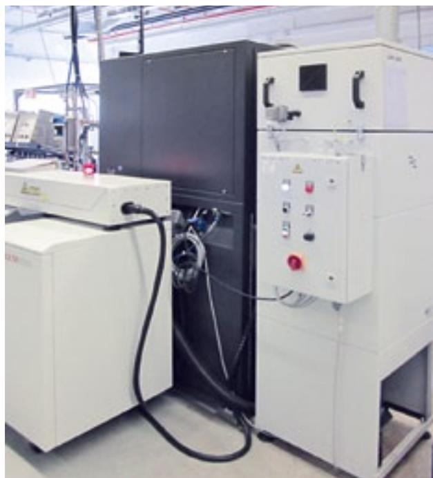
*Poste de soudage au laser avec technologie d'aspiration et de filtration*
