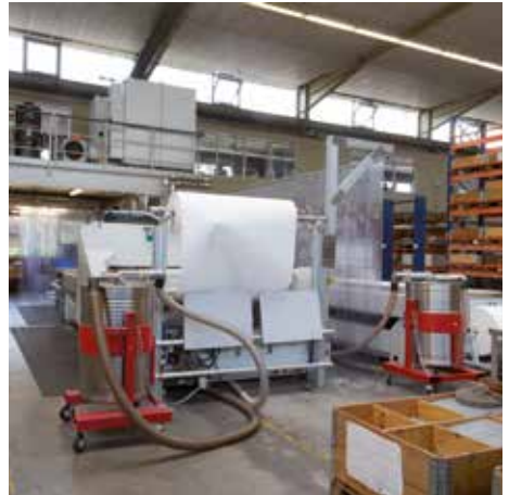
Vorabscheider-Behälter (200 Liter) mit Fasskipper
