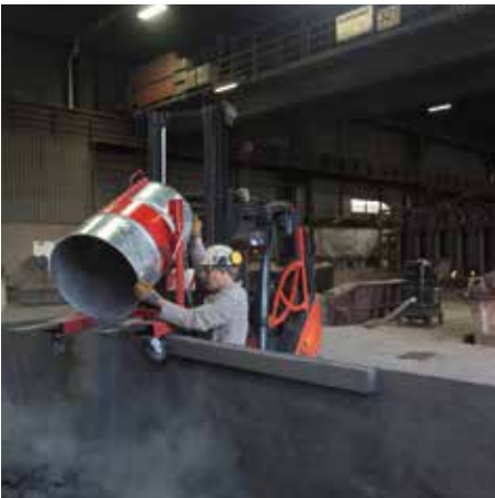
Vorabscheider-Behälter (200 Liter) mit Fasskipper
