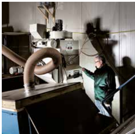
DS 65600 mit Patronenfilter, Staubklasse M
