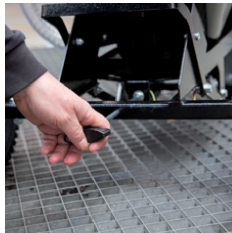
Hebel zur leichten Restschmutzentleerung
