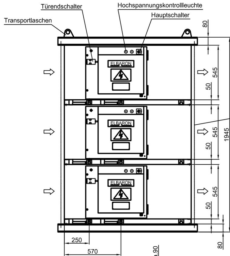
Transport-Gewindestangen M12 nach Aufstellung entfernen
