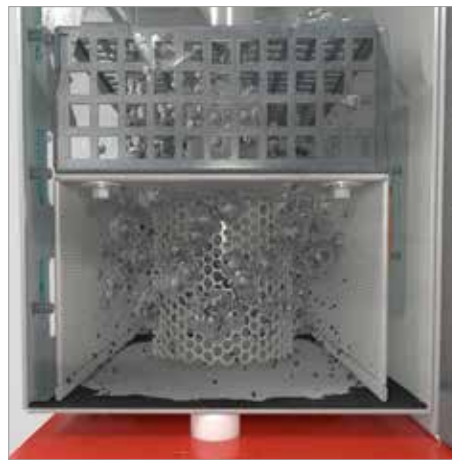
Flüssigkeit bindet die Partikel
