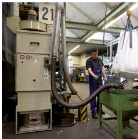
DS 63000 avec filtre à poches, classe de poussière H
