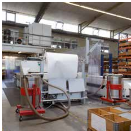
Conteneur de pré-séparateur (200 litres) avec benne à fûts
