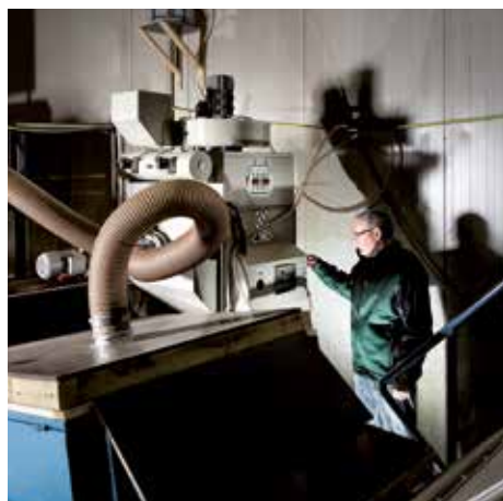
DS 65600 avec filtre à cartouche, classe de poussière M
