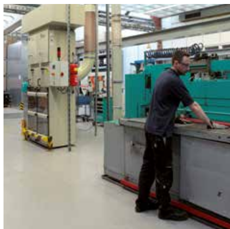
DS 64400 (tandem) avec filtre à poches, classe de poussière H
