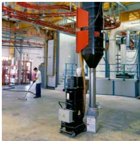
R01 R, avec silo, classe de poussière M
